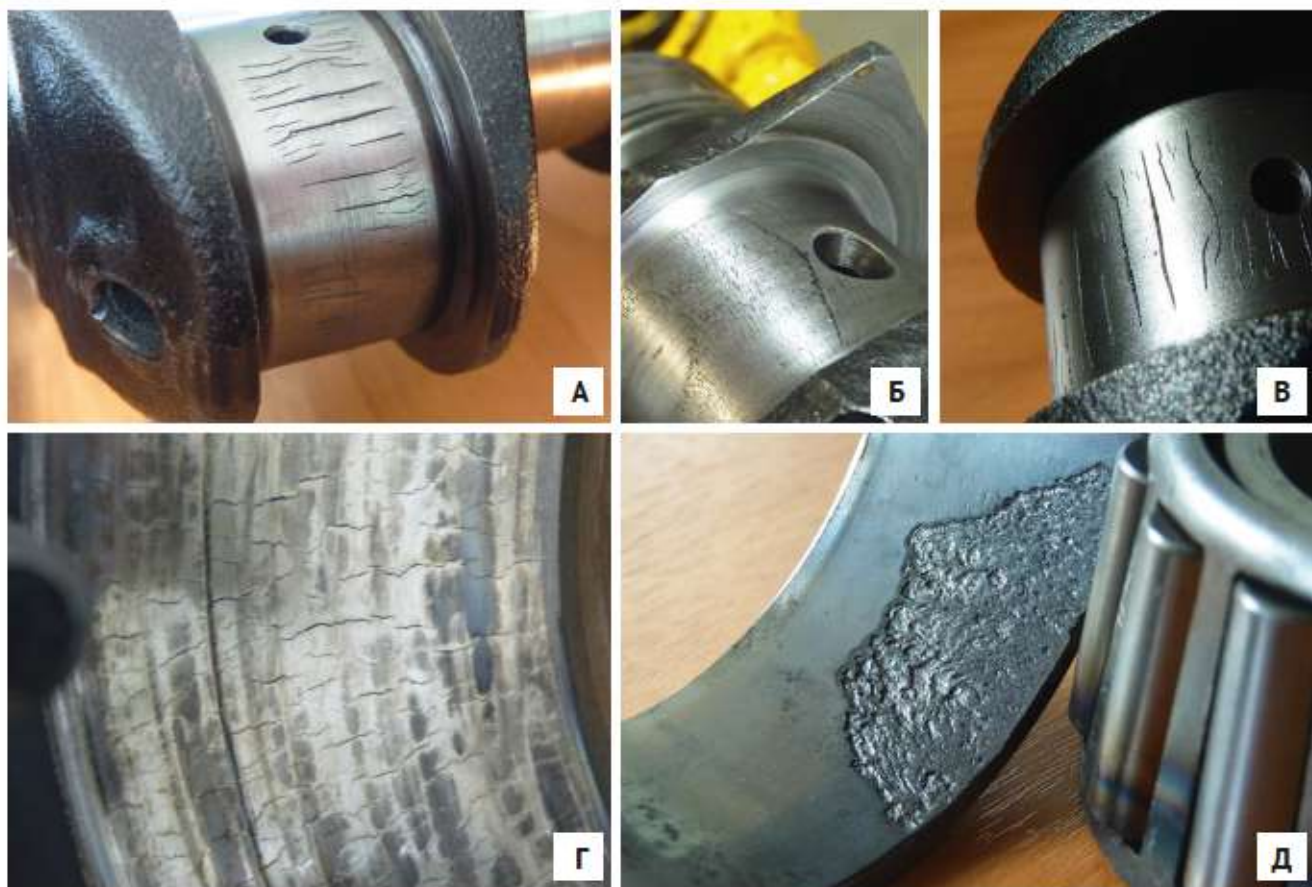
Рисунок 1 – Примеры обнаруженных трещин на шейках коленчатых валов двигателей (а, б, в), маховике коленчатого вала двигателя (г), выкрашивания на обойме подшипника (д), образованных в результате водородного насыщения.
